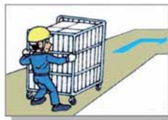
・長距離を移動しての停止 ・カーブを曲がる時は2 m手前で減速
